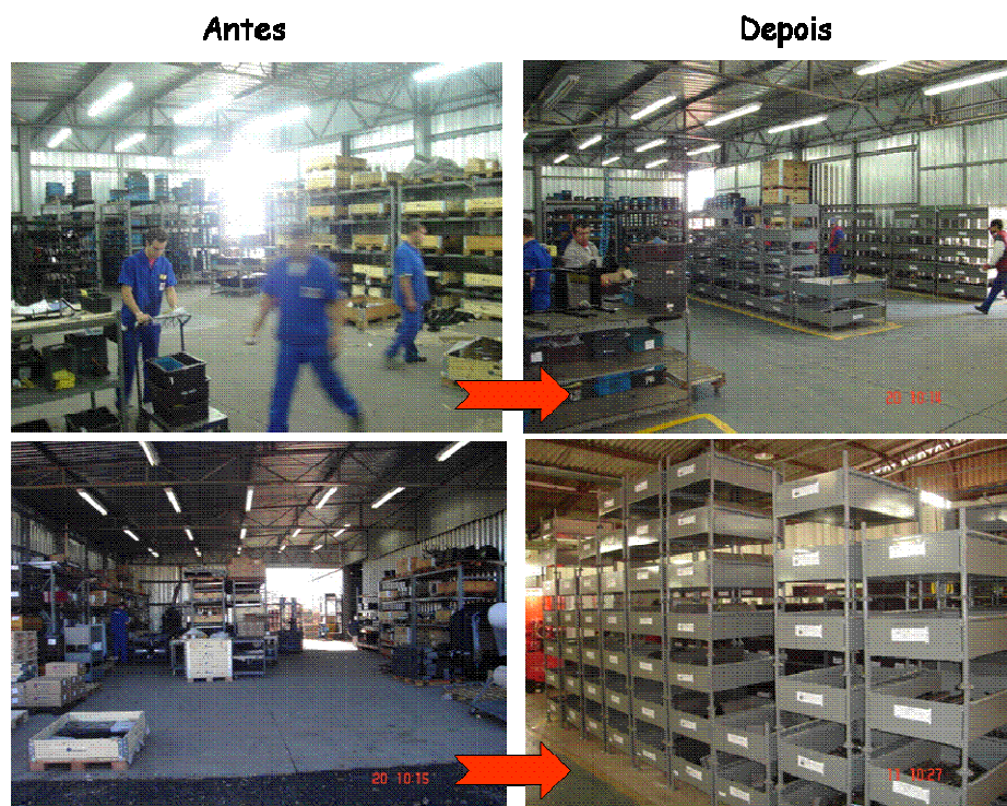
Figura 119: Substituição de um estoque empurrado para a expedição por um supermercado de produtos acabados.
