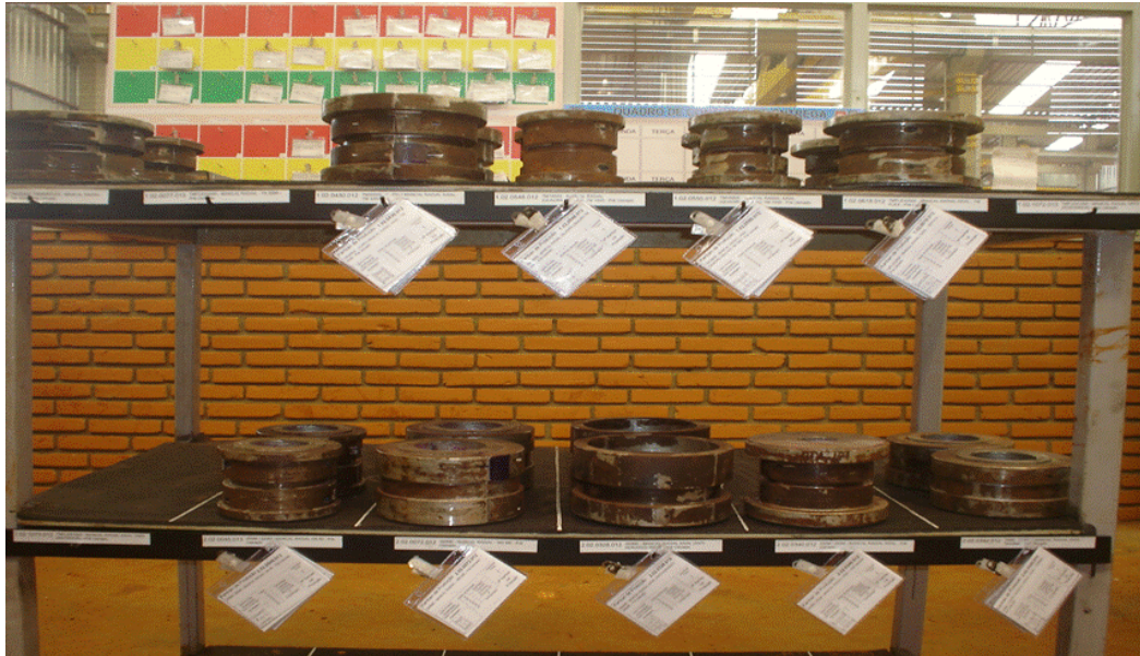
Figura 135: Supermercado de mancais ( loop 8 ) e quadros de kanban ao fundo.
