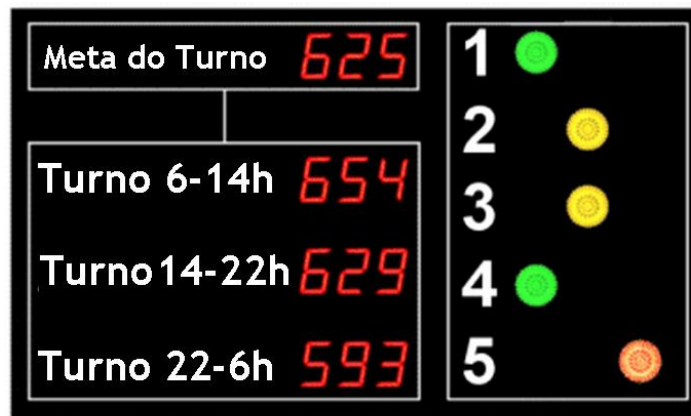
Figura 2.23 - Andon de acompanhamento de ritmo e produtividade Fonte - < http://www.london-electronics.com/andon-displays.php >
