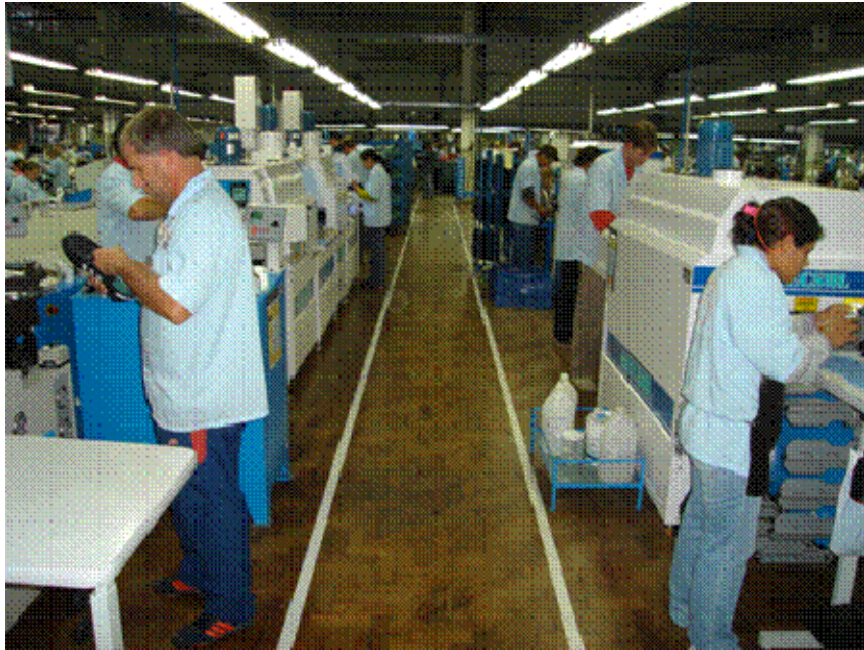
Figura 5.19- Montagem na célula em U, empresa C
