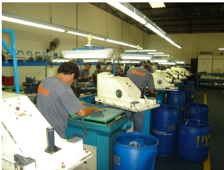
Figura 5.4- Área de corte demarcada com balancim de corte de vaquetas
