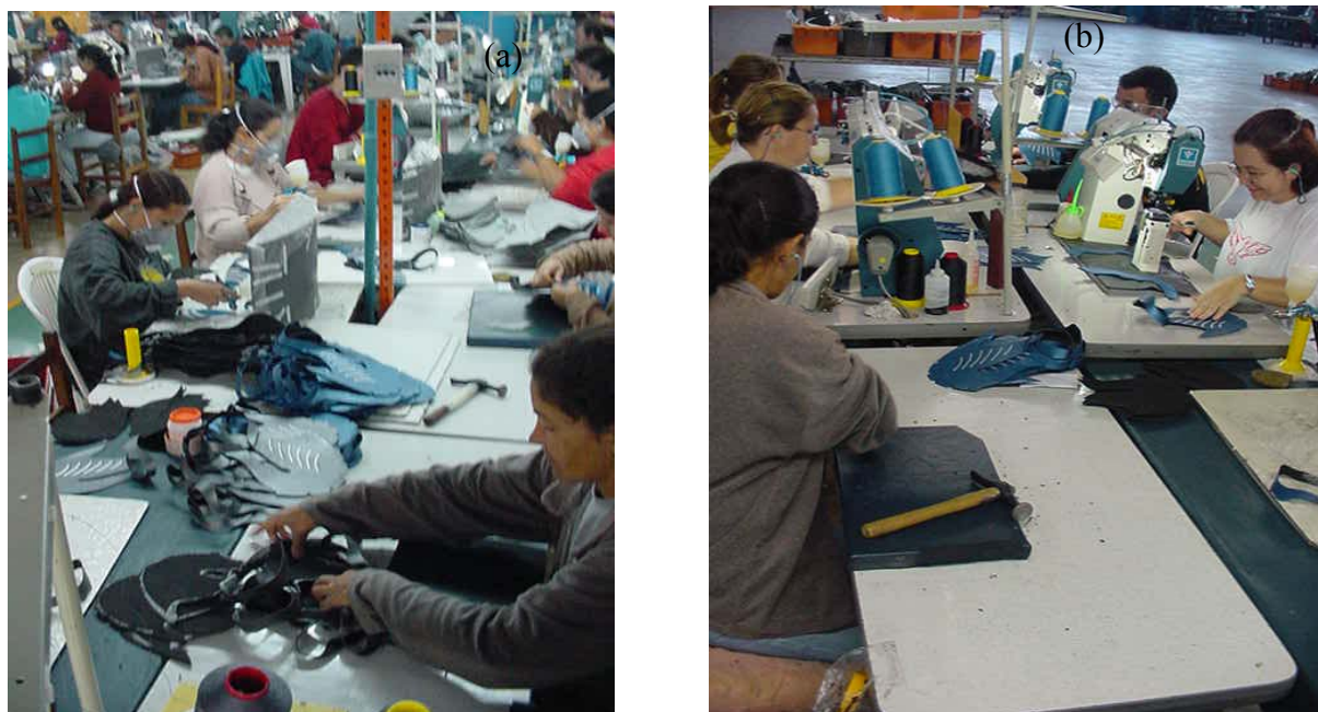
Figura 5.76- (a) Em lote (WIP), empresa H; (b) One-piece-flow , empresa H
