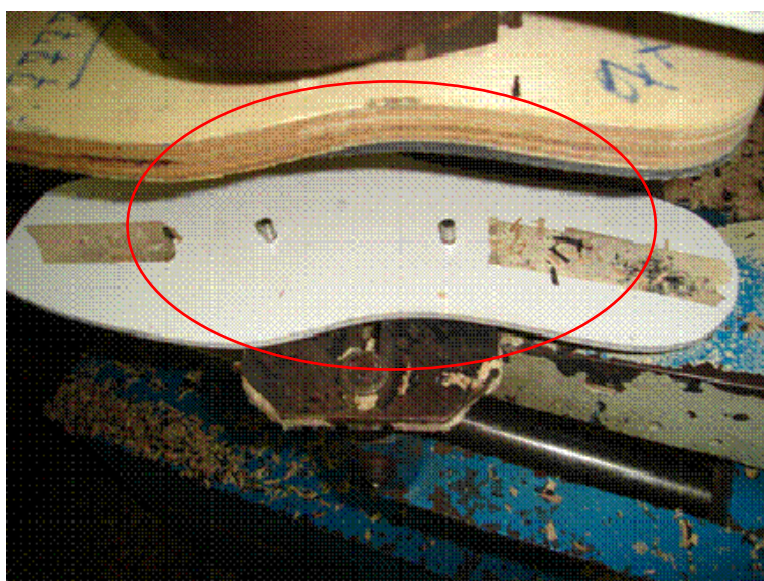
Figura 5.38- Pino funcionando como Poka Yoke , para fresamento do calçado
