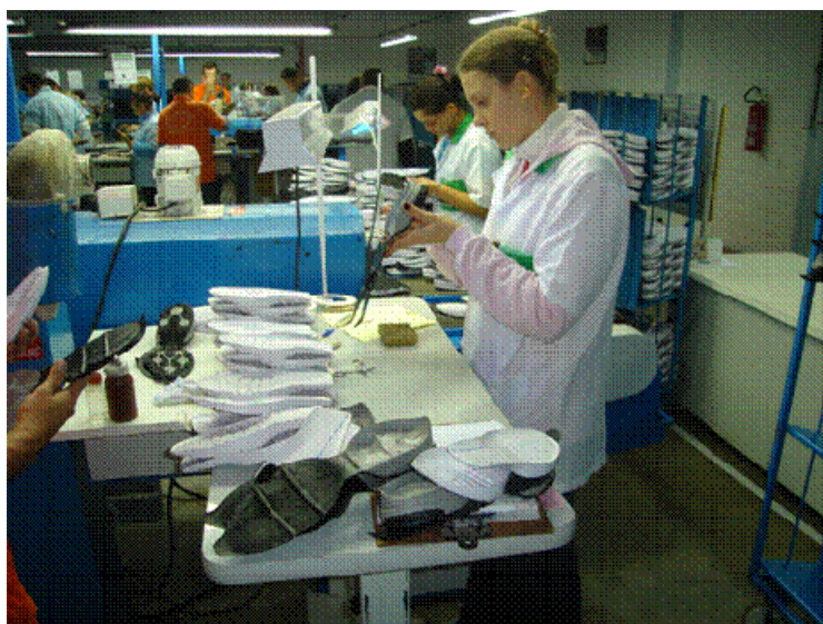
Figura 5.20- Inspeção visual em solas, Empresa C
