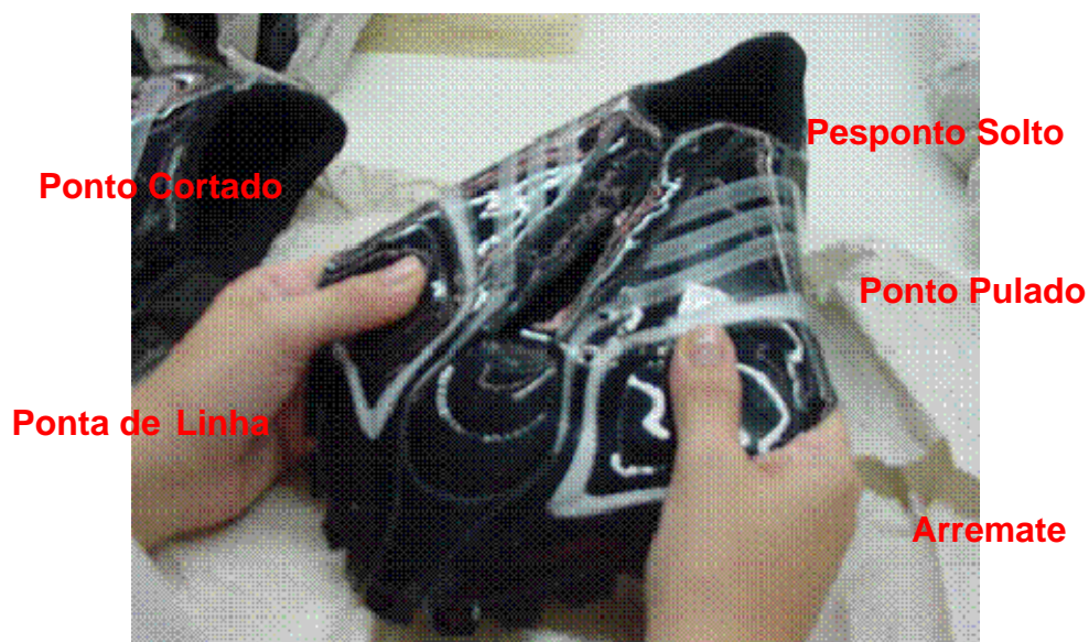
Figura 5.68- Inspeção da costura, empresa H, MARDEGAN, 2007
