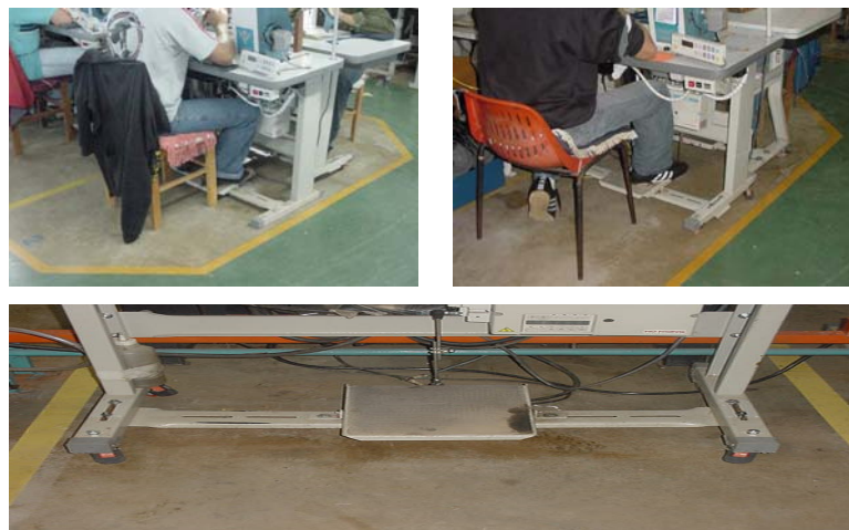
Figura 5.61- Rodas nas máquinas e mesas de trabalho
