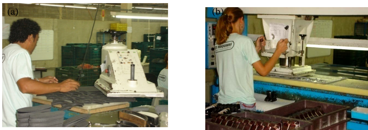
Figura 4.5- (a) Cortador no “balancinho de braço” (b) Cortadora no “balancinho de ponte”
